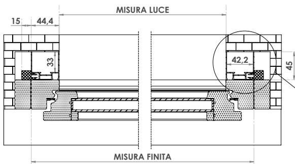
HABILITATION DE LA PRÉDISPOSITION POUR L'ENCASTREMENT DU MODÈLE WIND 42 APRES ROTATION DE 90° DU PROFIL
