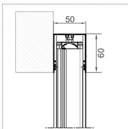
Si non spécifié autrement lors de la commande, la moustiquaire est fournie de série avec des trous en position frontale et des petits bouchons cache trou.
