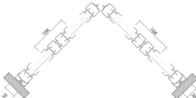
SECTION HORIZONTALE 3 PANNEAUX A SUIVRE D'ANGLE
