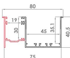
Le profil supérieur de la prédisposition avec rail store de 75 on obtient à travers sa coupe, comme dans le dessin (*partie pointillée en rouge*) fourni de série dans kit.
