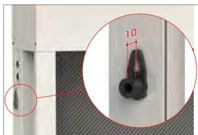
■ Rail avec compensateur doté de réglés : **les réglés** ou **registres de réglage** positionnés dans les rails latéraux garantissent l'installation dans des ouvertures hors équerre ou en présence de surfaces irrégulières et non homogènes. Réglé de compensation **jsuqu'à 10 mm**.
